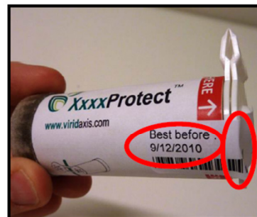
1.) Überprüfung des empfohlenen Verwendungsdatums ('best before') und der Unversehrtheit des Siegels.
