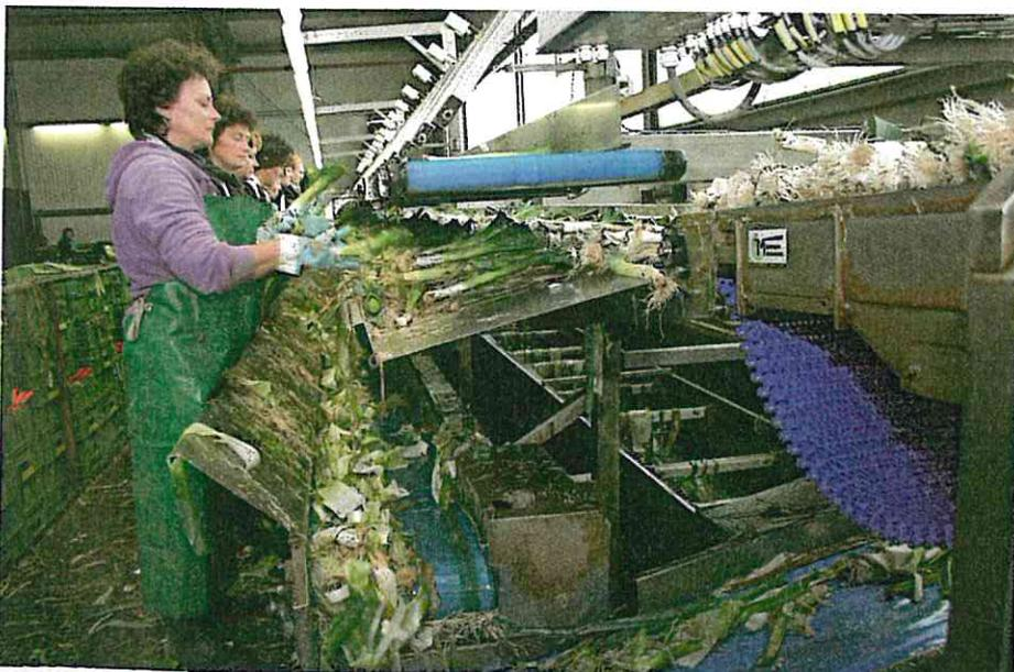
Drei Förderbänder sind in Bewegung: von rechts oben wird der geschnittene und gewaschene Porree hinter dem Arbeitstisch entlang zu allen Mitarbeitern befördert, über dem Arbeitstisch werden die fertig geputzten Stangen und unter dem Arbeitstisch die Abfälle abtransportiert; per Knopfdruck kann die erste Arbeitskraft in der Reihe den Schieber auslösen, der neue Porreestangen auf den Arbeitstisch schiebt
